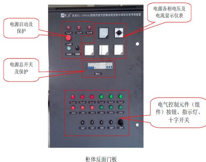
图 1 实训柜体、门板电气控制元件（组件）、仪表
